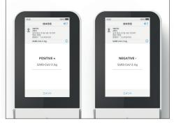
8. 測定結果は、検体滴下後、約12分で画面に表示されます。左側の画面はSARS-CoV-2抗原の陽性(POSITIVE+)結果例で、右側の画面はSARS-CoV-2抗原の陰性(NEGATIVE-)結果例です。測定を完了するには「終了」をタップし、コメントを残す場合や、測定結果を除外する場合は「コメント」をタップします。その後、画面に従いタップしてホーム画面に戻ります。全ての測定結果はルミラ 測定機器を使用して確認します。
