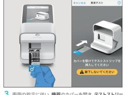
3. 画面の指示に従い、機器のカバーを開き、テストストリップを優しく挿入します。その際にストリップの左側にある黒いアライメント・リブを機器の黒線とぴったり合わせます。画面に指示が出るまで検体は滴下しないでください。新しいロットのテストストリップを初めて使用する場合は、ロット較正ファイルをインストールしてください。ルミラ・プラットフォームユーザーマニュアルの第2.8章を参照してください。
