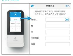
1.機器のホーム画面から検体測定を選択し患者情報の詳細をキーボードまたはバーコードスキャナーで入力します。バーコードスキャナーの使用法は、ルミラ・プラットフォームユーザーマニュアルの第10章で確認します。
